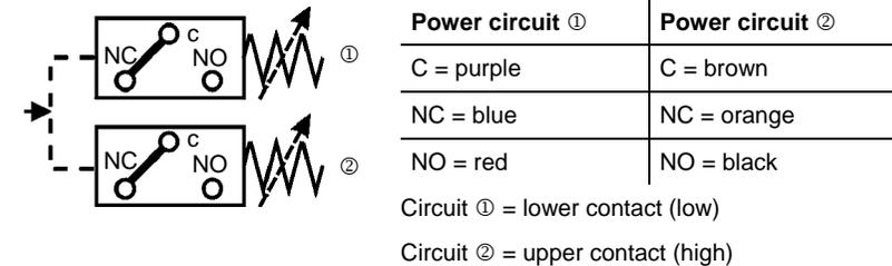
Fig. 5 Wiring Code
