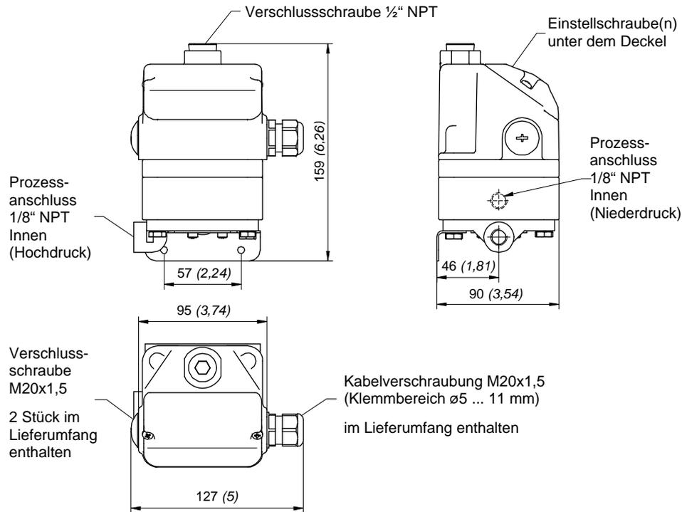
Bild 8: Metall-Membran-Differenz-Druckschalter Typ DPD1T .../DPD2T ...
