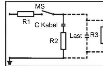
Bild 1: Schutz bei kapazitiven Lasten
