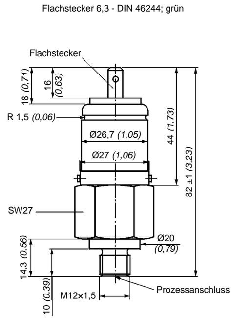
Bild 8: Kolben-Druckschalter
