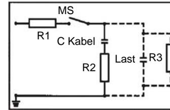
Bild 1: Schutz bei kapazitiven Lasten
