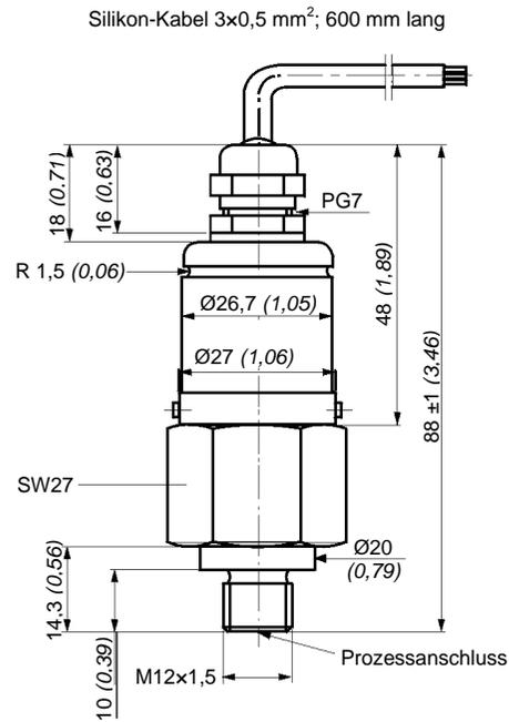
Bild 7: Kolben-Druckschalter
