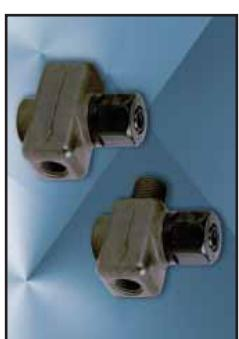
Barksdale Druckbegrenzungsventil (PPV) optimiert die Sicherheit Ihrer Anlage. Dieses wichtige Ventil verfügt über einen Druckanschluss mit Außengewinde, damit es direkt an den Druckluftspeicher angeschlossen werden kann. Es wird im Werk auf den exakten, vorgeschriebenen Betriebsdruck eingestellt.
